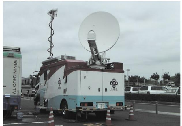
衛星通信用パラボラと簡易型マイクロ波通信システム
