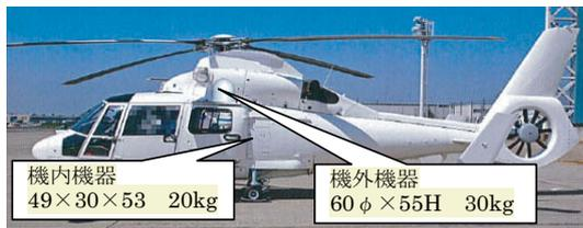
図2 ヘリサット機器概要
