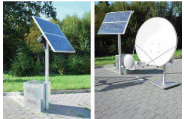
海外におけるソーラーパネルを利用したVSATの例
