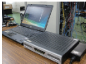
左：HUB装置 下：VSATのIDU（手前の装置） （比較のためノートパソコンを並置）
