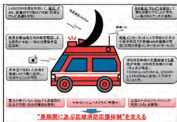
(図1) 無線中継車機能概要図
