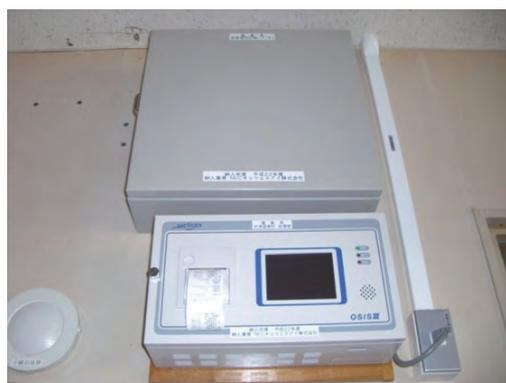
写真 6.33 現在は地上回線で配信している計測震度計 (写真下が処理部)
