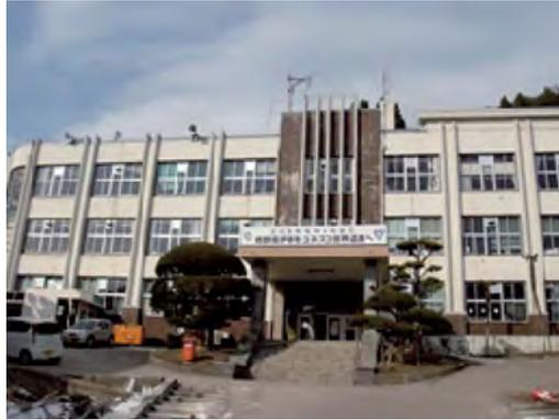
**写真 6.8 釜石市役所 階段部分まで津波がきたが VSAT は無事**
