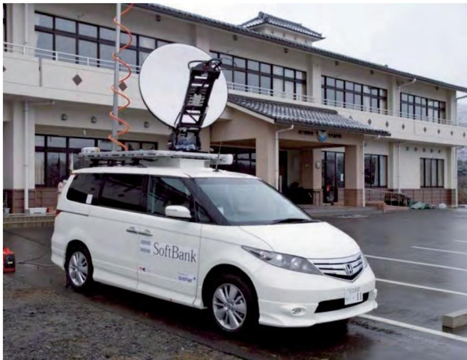
図 11 ソフトバンクモバイル車載型基地局
