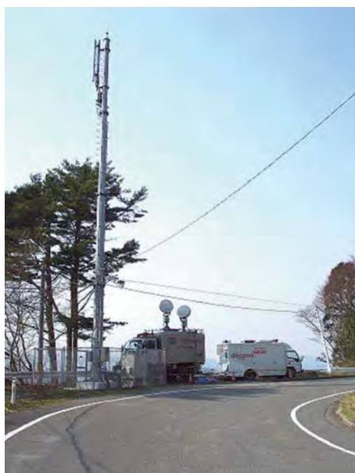
図2 NTT ドコモマイクロによる伝送路復旧
