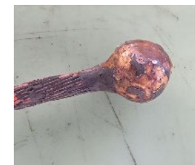
【能登半島地震での輪島市大規模延焼火災の現場で見つかった溶融痕】
